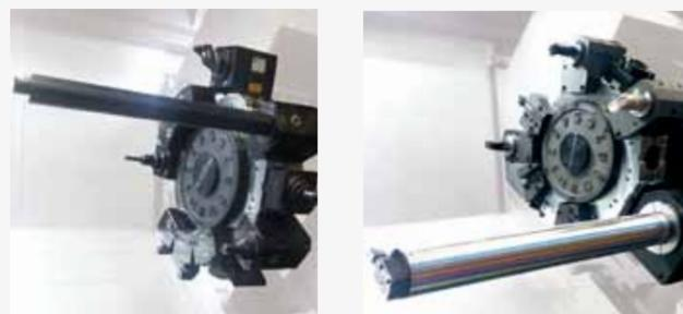
长镗杆刀架选项可让您轻松加工深孔，最大程度节约切削时间。请咨询斗山专家，获取详细信息。
